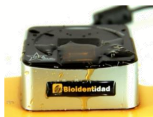
Sensor dactilar protegido contra derrames de líquidos e ingreso de polvo
