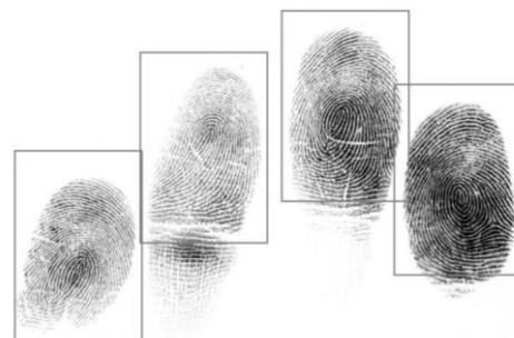
El Bioidentidad FS64 realiza la detección automática de cada dedo en las capturas simultáneas.
